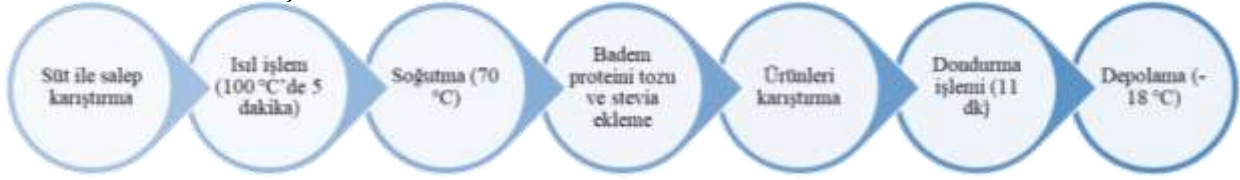
Şekil 1. Dondurma üretim şeması
